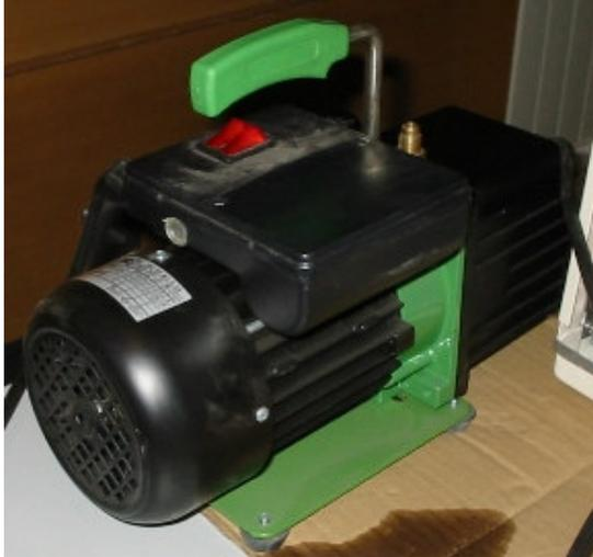
**Figura 2.-** Bomba de vacío de servicio frigorista, la conexión de latón (dorada) es la toma para la aspiración, y debe conectarse a la instalación a través del puente de manómetros, los gases vaciados son evacuados a la atmósfera a través de una purga, en ocasiones debajo del tapón del aceite (OIL), en ocasiones a través del asa. Debe mantener la precaución de no evacuar gases contaminantes, nocivos o inflamables por el peligro que supone para usted y el medio ambiente.
