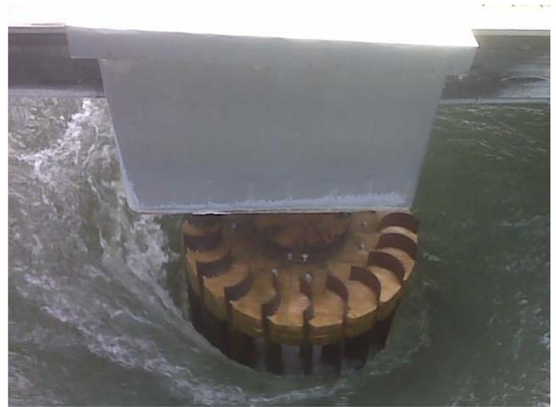
La turbina ataca directamente un generador, de forma tan sencilla que recuerda a las antiguas dinamos de las bicicletas.
