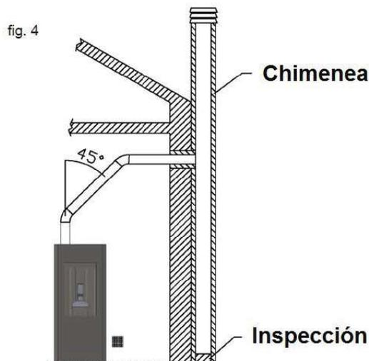
El extremo del sistema de evacuación debe tener una distancia mínima de 30cm de la pared exterior, con el objetivo de garantizar una evacuación correcta de humos generados por la combustión.
