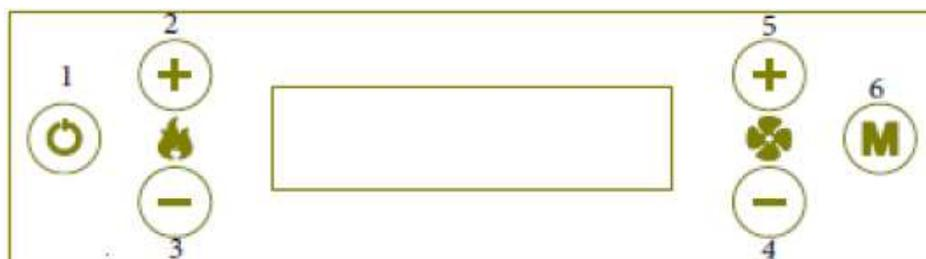
La pantalla es táctil. Está equipada con un LED el cual nos indica cuándo la estufa está en funcionamiento, una pantalla LCD de 16 caracteres en dos líneas y un sensor para la recepción de señales IDRA con un control remoto de infrarrojos.
