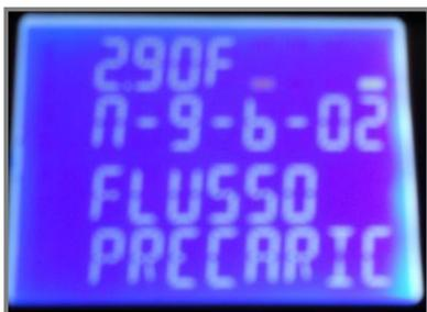
CONFIGURACIÓN DEL FLUJO DURANTE LA PRECARGA EN m/s (2,9)
