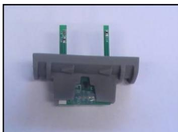
ESTE SENSOR DEBE INSTALARSE EN EL TUBO DEL AIRE COMBURENTE Y MIDE LA “VELOCIDAD DEL AIRE COMBURENTE EN M/S”
