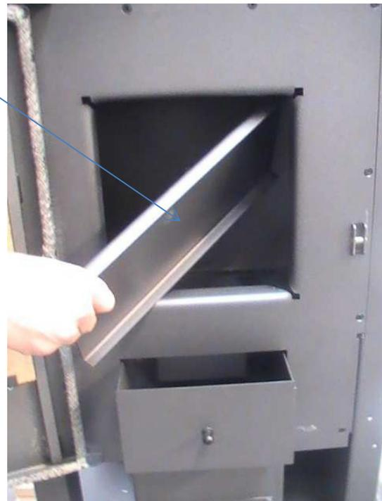
2 QUITE LOS PANELES DE INSPECCIÓN LATERALES DEL ZÓCALO
