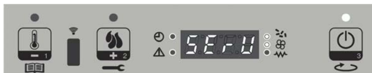
Visualización del mensaje que se desplaza (cada minuto durante 10 segundos) en la pantalla: SERVICE
