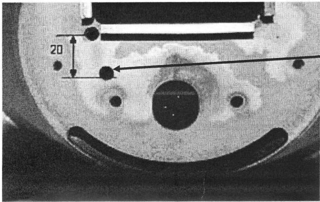
Nuevo orificio a realizar (diámetro 6 mm)
