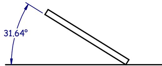
*Inclinación del panel sobre la cubierta*
