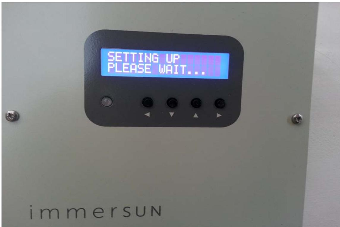
Chequeando la dirección de la corriente , este proceso se realiza con la carga activada.
