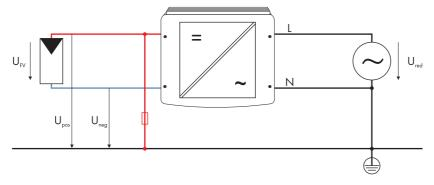
El siguiente diagrama muestra el desarrollo del potencial de los polos positivo (en rojo) y negativo (en azul) del generador conectado a diferentes inversores.
