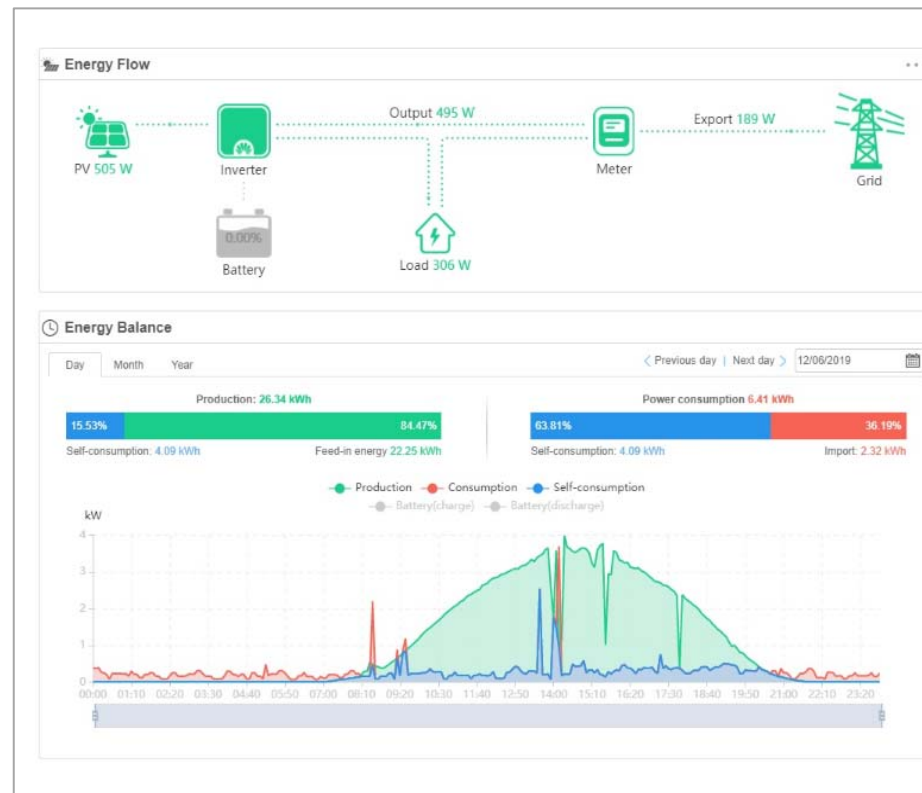
Ejemplo de monitorización de instalación con inversor Huawei.
