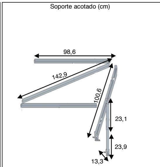
Ejemplo de disposición de los anclajes en soporte
