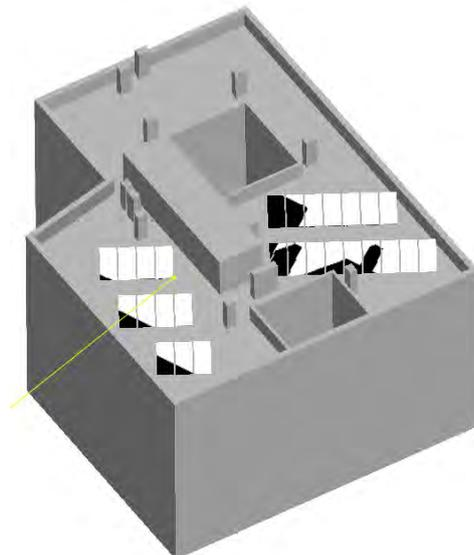
Finalmente, teniendo en cuenta el tiempo que ha permanecido entre las 10 y las 14 bajo el sol o bajo la sombra de cada sección del panel, se muestra en colores falsos (rojo máxima insolación = 4 horas; azul mínima insolación = 0 horas) el resultado.
