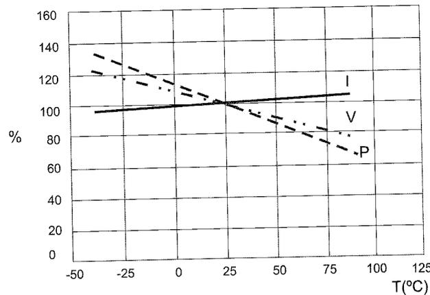
Figura 4.14. Variación de las principales magnitudes eléctricas de una célula solar fotovoltaica en función de la temperatura.
