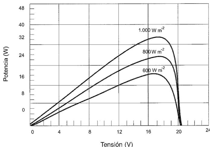
Figura 4.12. Variación de la curva característica potencia-tensión de una célula solar fotovoltaica con la irradiancia solar.
