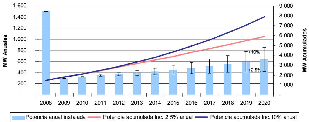
**Figura 3: Estimación de la potencia instalada hasta 2020 según la aplicación de la propuesta de RD, considerando un incremento anual de potencia entre un 2,5% y un 10% anual.**
