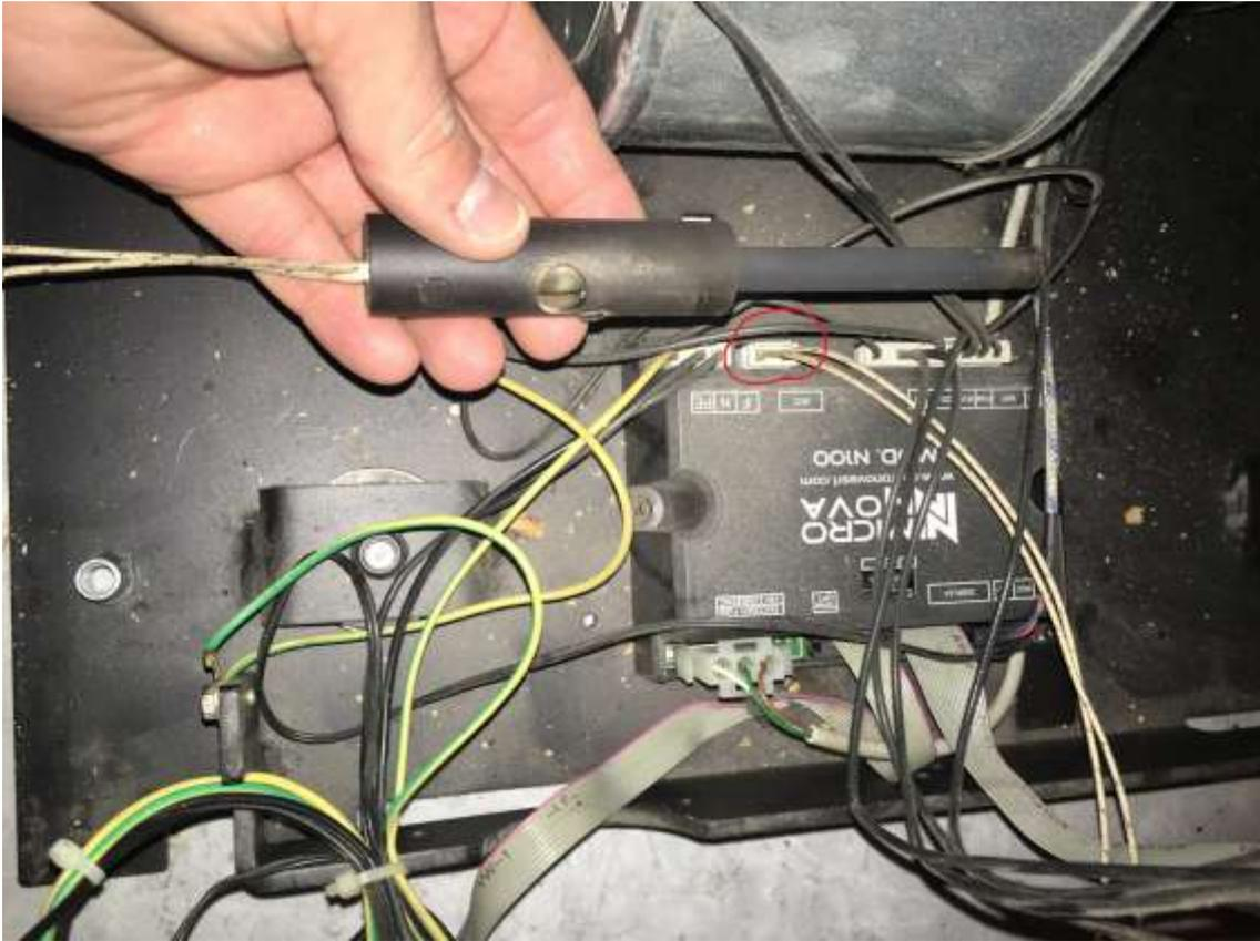
Mide 154mm y 9.9mm de diámetro, y de 300w, lleva dos cables y un conector que va a la caja de conexiones que veis debajo, va con un conector especial que cuando cambiéis la resistencia es posible que no sea igual, pero se puede cortar y empalmar con una regleta eléctrica
