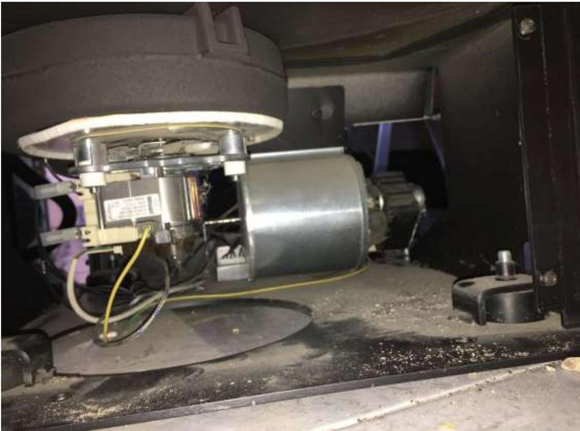
Parte abajo por delante, detrás de la placa es el motor y ventilador que extrae los humos
