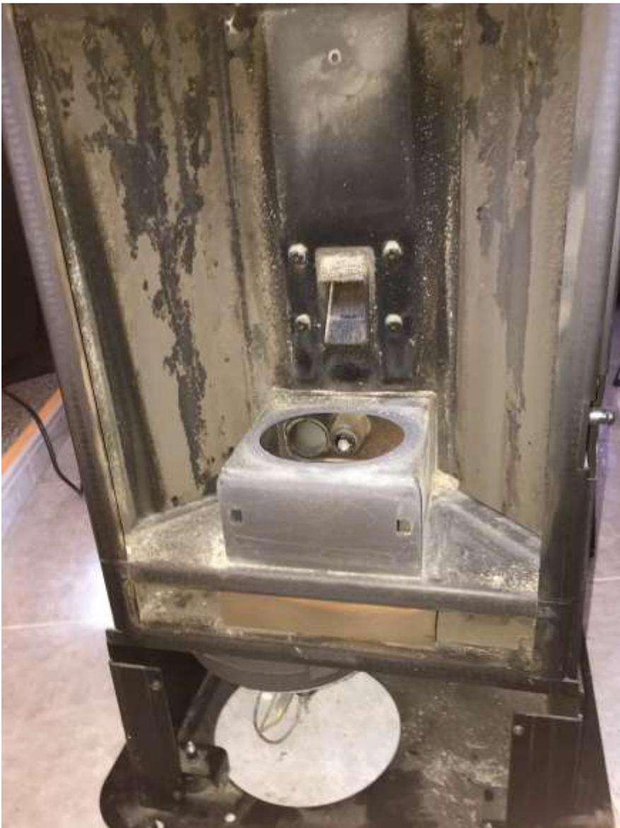
Parte delantera sin piezas de vermiculita y carcasas laterales, puerta, y baja desmontadas.
