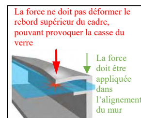
Figure 1a : Position de la Force de serrage de la bride
